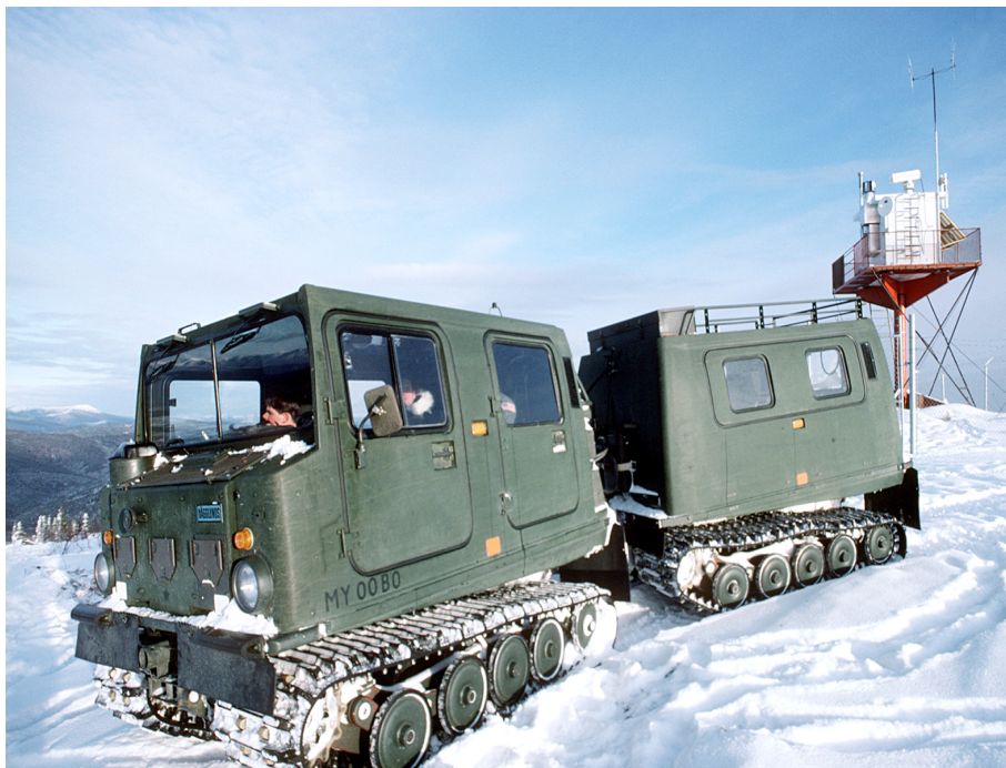
Vehículo a oruga todoterreno Bandvagn/Hagglunds para transporte de personal y carga sobre nieve y hielo. Crédito: NZARP.
