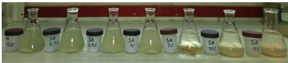
Tratamientos del test de jarras con sulfato de aluminio
