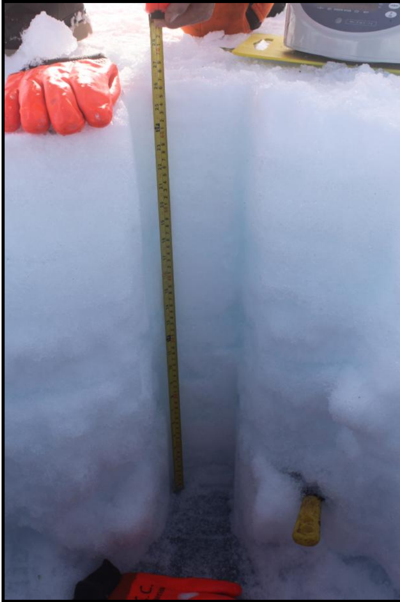
Figura 8.-Medición del espesor de la capa de nieve
