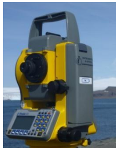
Estación Total Trimble M3, Precisión 5ö
