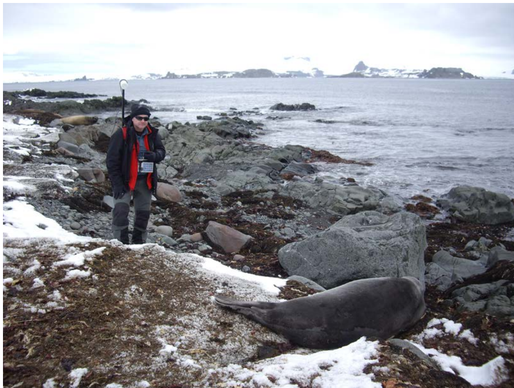
Fig. 7. Medida de la intensidad del Campo magnético total con magnetómetro de precesión de protones en Isla Robert.
