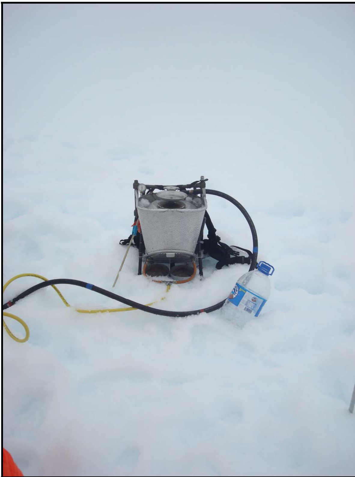
Figura 6.- Detalle de la sonda Heucke utilizada para realizar las perforaciones
