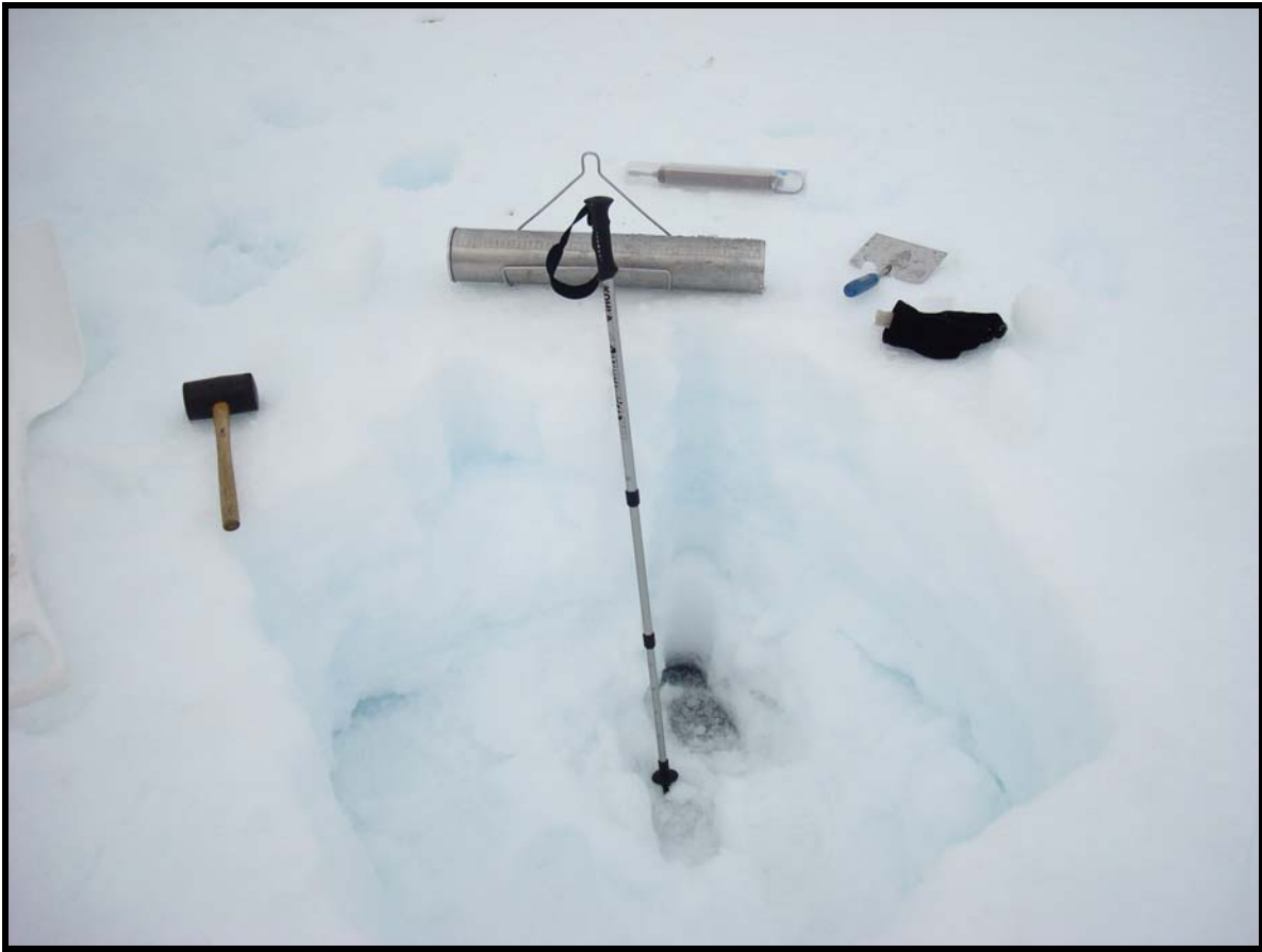
Figura 8.- Detalle de pozo de acumulación y equipo utilizado.
