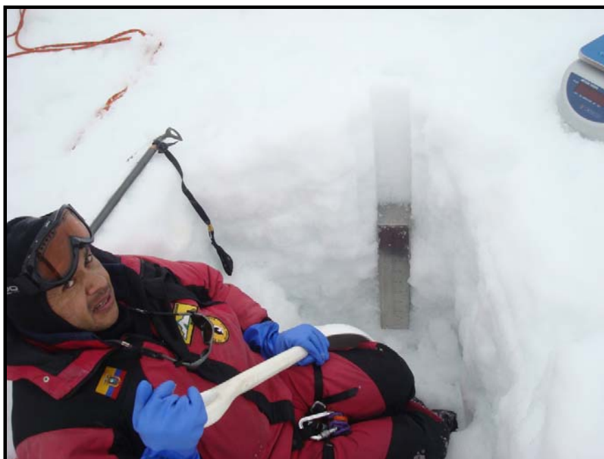
Figura 9.- Medición de la densidad de la capa de nieve en el sector B
