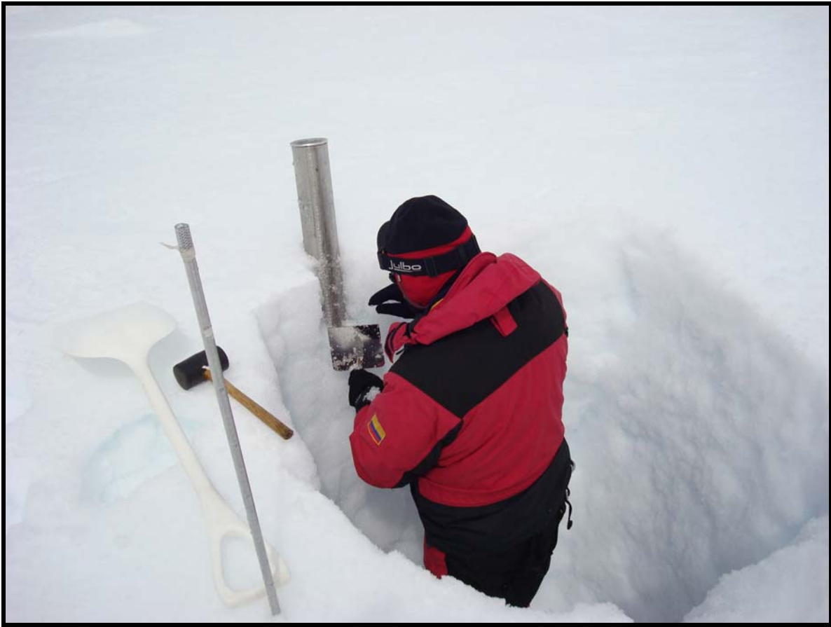
Figura 10.- Trabajo para medir la densidad en el pozo de acumulación
