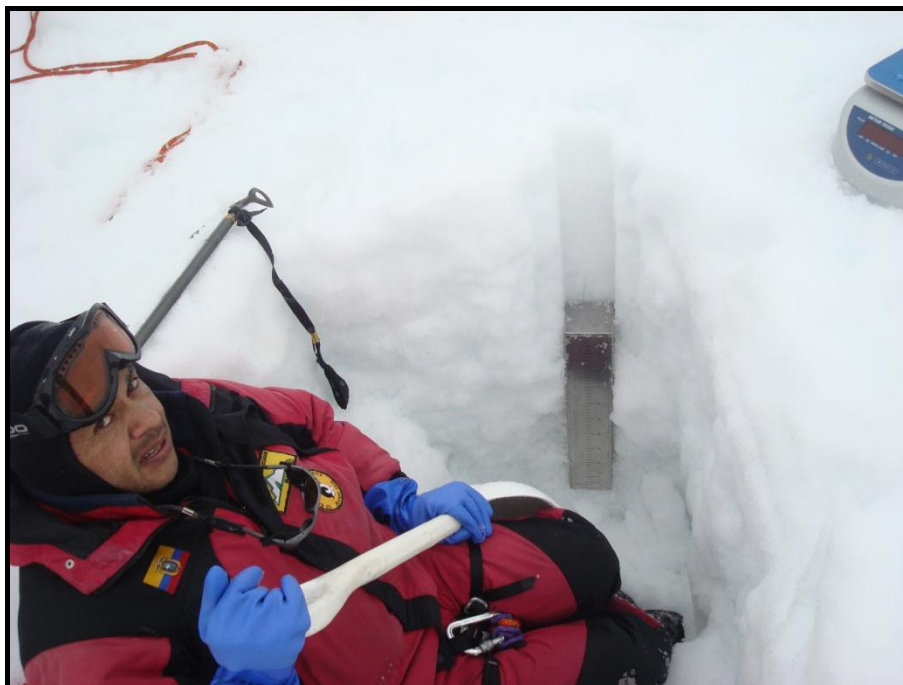
Figura 9.- Medición de la densidad de la capa de nieve en el sector B
