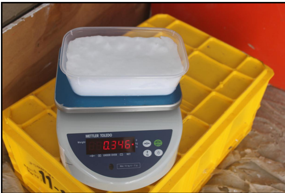
Figura12.-Proceso de pesada d los lisímetros en el área de trabajo (contenedor)
