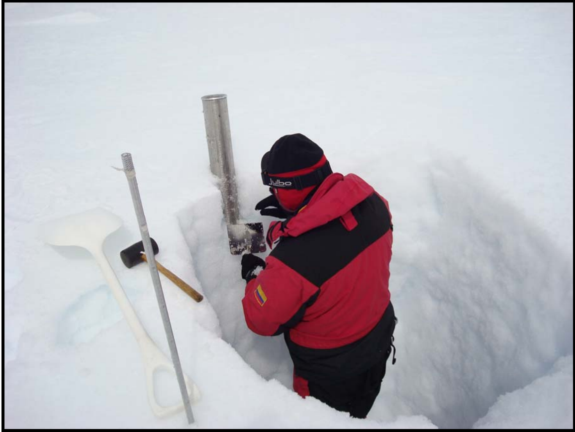
Figura 8.- Trabajo para medir la densidad en el pozo de acumulación
