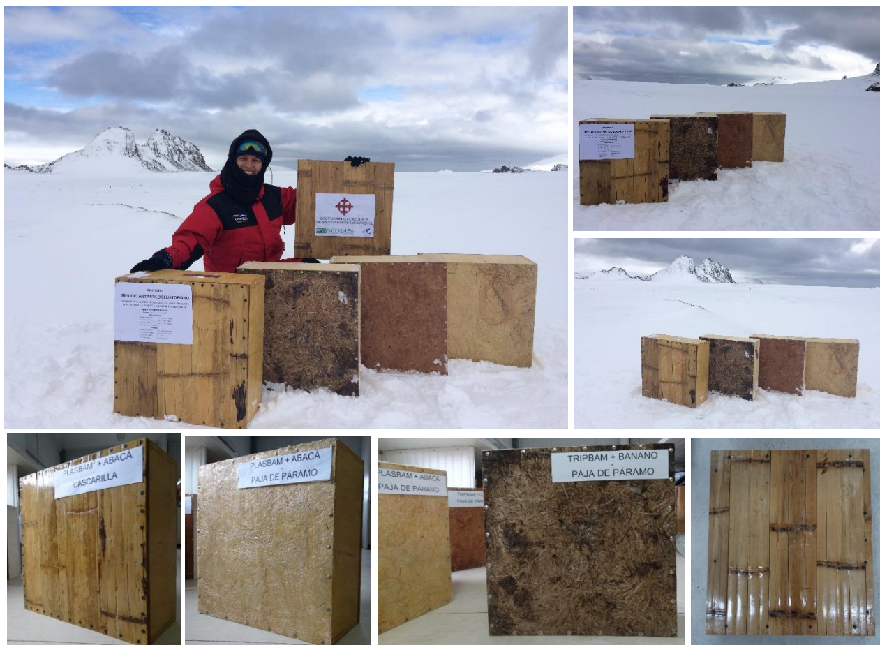
Fotografías 4, 5, 6, 7, 8, 9, y 10. Prototipos de paneles compuestos de bambú + fibras y/o residuos agrícolas o agroindustriales para ejecución de pruebas de conductividad térmica.
