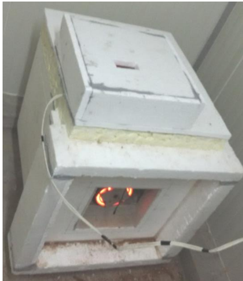
Figura 1. Caja fabricada para los ensayos de conductividad térmica. Fuente: Equipo humano de investigación – Proyecto "Refugio Antártico Ecuatoriano".
