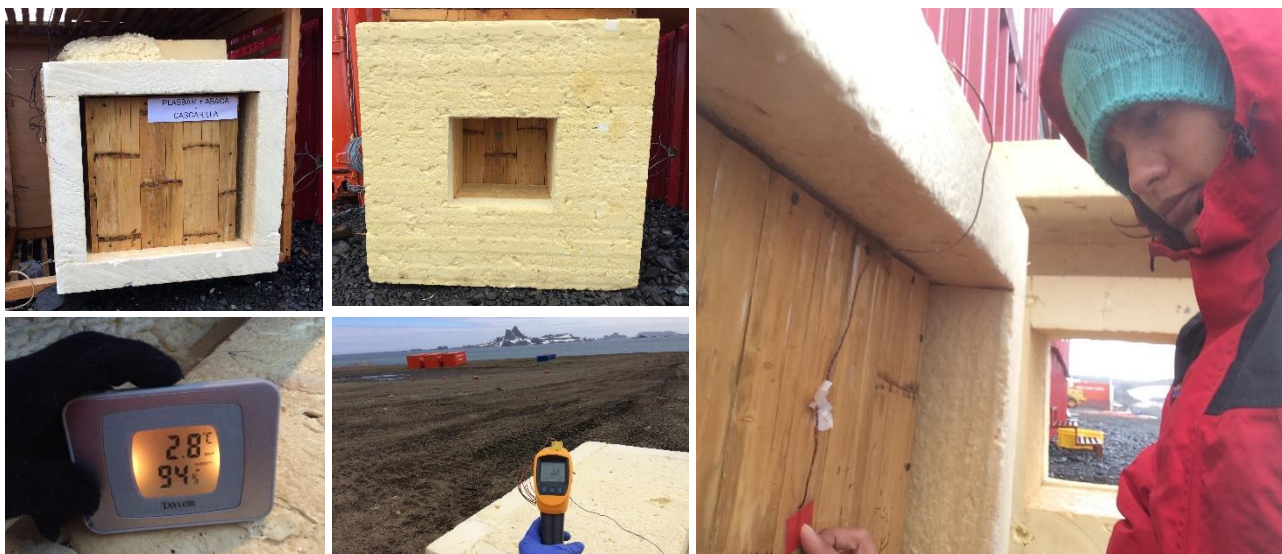
Fotografías. 11, 12, 13, 14 y 15. Ejecución de pruebas de conductividad térmica, colocación de sensores y termocuplas para medición de variables: temperatura en cara interna y cara externa de los prototipos expuestos a la intemperie, medición de tiempos/ciclos/periodos, temperatura ambiente y %C.H.
